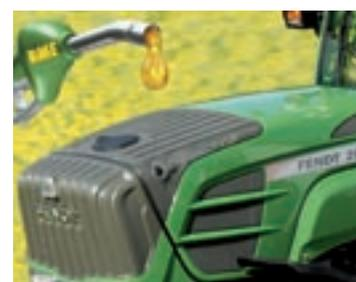
Il 200 Vario è predisposto senza alcuna limitazione all'alimentazione a biodiesel. L'alimentazione a metil estere di colza secondo DIN EN 14214 è ammessa già di serie. Ciò consente di usufruire di enormi vantaggi sui costi poiché non occorre né un'assicurazione aggiuntiva né alcuna modifica.
