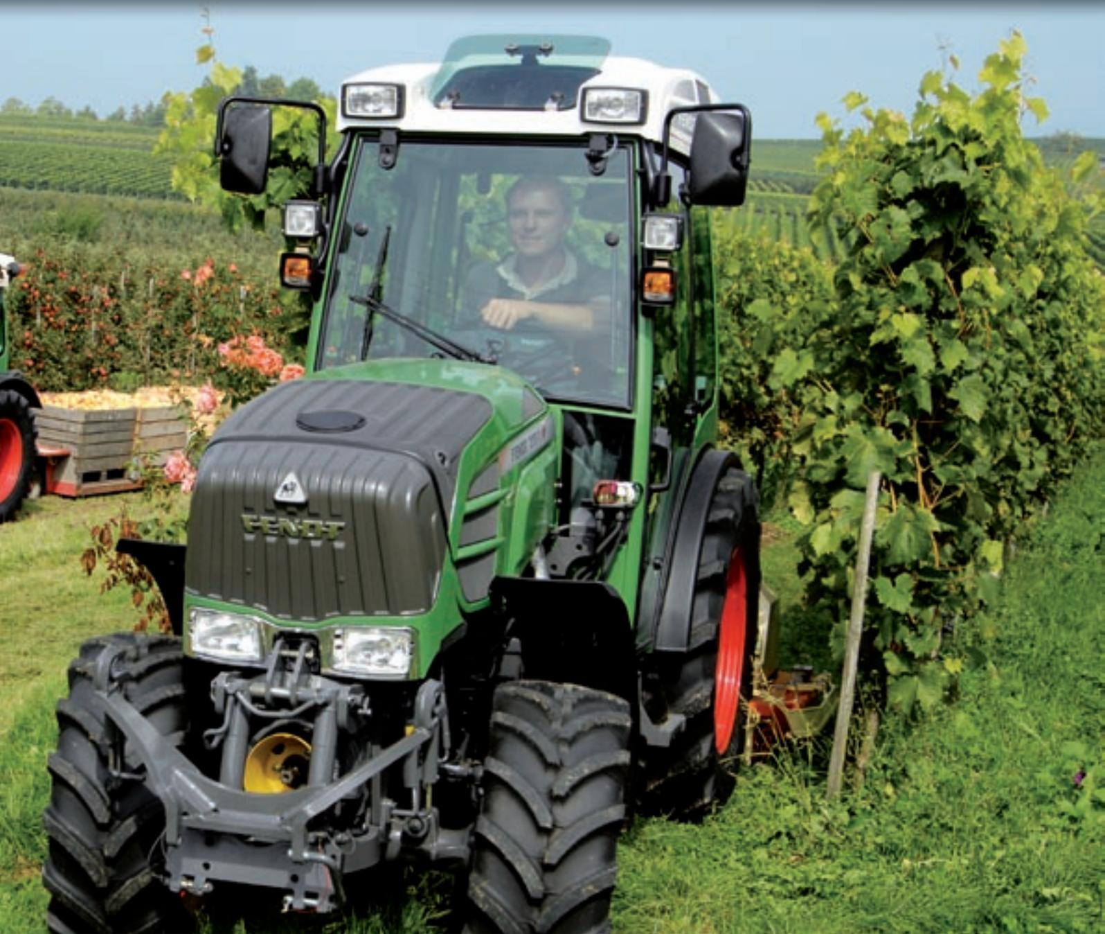
dispongono sia di riscaldamento che di ventilazione. Nella versione a tetto basso il Vario V con pneumatici di serie presenta un'altezza di soli 2,21 metri e la versione F di soli 2,29 metri.
