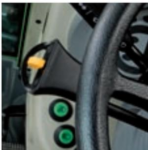
Con la leva di inversione è possibile cambiare comodamente direzione di marcia con la mano sinistra.
