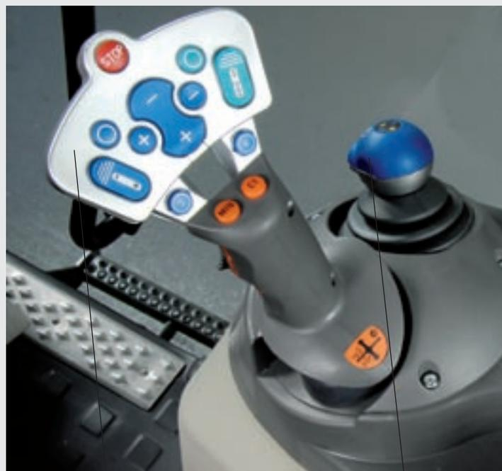
**Joystick multifunzione** con tasti di comando per sollevatore posteriore, distributori, 3° e 4° circuito idraulico, tasto memoria giri motore e Tempomat
