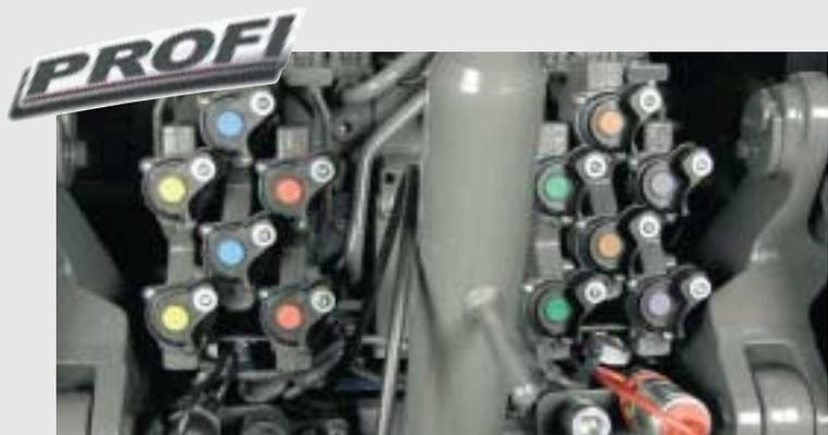
**Le moderne attrezzature richiedono un impianto idraulico sempre più flessibile e potente. Per massimizzare la produttività è necessario garantire movimenti rapidi dell'attrezzatura e portate idrauliche elevate. L'impianto idraulico Load-Sensing del 900 Vario, dotato di distributori proporzionali a comando elettronico fornisce i migliori presupposti.**
