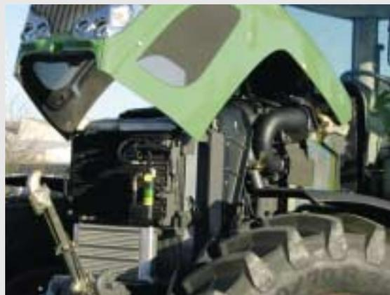
Il 900 Vario monta un gruppo radiatori ben dimensionato concepito per una manutenzione semplice. La gestione elettronica della ventola di raffreddamento, Visctronic, agisce in funzione della temperatura di ogni radiatore. L'efficienza è molto più alta rispetto a sistemi pilotati solo dal radiatore del motore ed il fatto che non sia più necessario prevedere delle riserve per il raffreddamento si rispecchia anche nei consumi..
