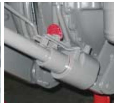
Stabilizzatori laterali idraulici per bracci inferiori
