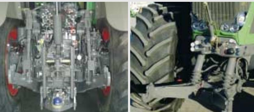
La capacità dei sollevatori anteriore e posteriore del 900 Vario è stata ulteriormente incrementata rispetto al suo predecessore. Il sollevatore EHR ha una capacità di sollevamento di ben 188 kN e quello anteriore di 55,5 kN. Il 900 Vario è quindi in grado di portare anche attrezzature molto pesanti.
