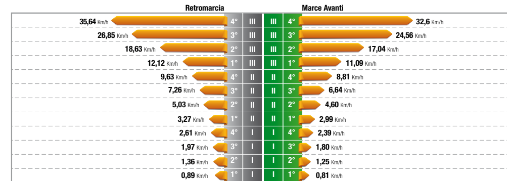
Grafico delle velocità in km/h con pneumatici 11.5/80-15.3 dei trattori versione AR e RS. Il grafico mette in risalto la perfetta progressione dei rapporti, senza nessuna sovrapposizione di velocità in nessuna gamma di avanzamento.
