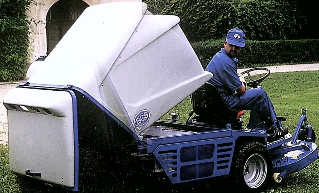
Il ribaltamento del cesto raccogliherba è idraulico, con scarico a terra per quanto riguarda i modelli 101 e 103 e con scarico alto fino a 190 cm. per il modello 205. La capienza dei cesti di raccolta è di 600lt. per le versioni 101 e 103 e di 800lt. per la versione 205.
