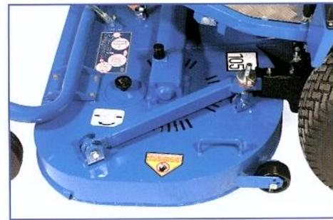
Gli apparati falcianti da cm.122 adottano un'affidabile trasmissione ad ingranaggi. Sono previsti, con lo scarico laterale, adattabili a tutti i modelli MATRA e con scarico centrale predisposti alla raccolta, per i modelli 101, 103 e 205. Il sistema di taglio è costituito da due dischi entrambi con due lame 'speciali' snodate antiurto.
