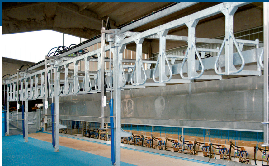
Frontale con sistema oleodinamico di sollevamento e arretramento Breast rail with hydraulic moving and cow indexing
