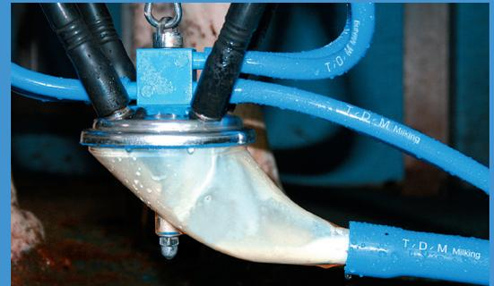
Gruppo di mungitura Conan per flussi di latte elevati (Brevetto TDM)
