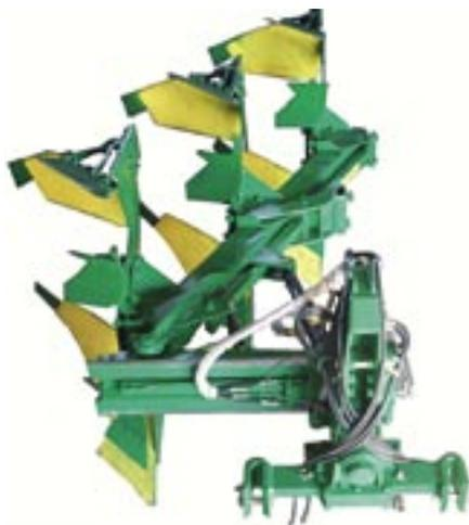
ne dentro e sopra il solco da uno sino a cinque corpi. Grazie al porta attrezzi dotato di un particolare regolatore direzionale, permette l'eliminazione di tutte le tensioni laterali e favorisce un'aratura regolare. Le parti di usura nello spostamento sono in bronzo e facilmente sostituibili. Per agevolare le lavorazioni a fine campo, la MORO PIETRO MECCANICA ha realizzato un avantreno a finitura rapida che interagisce con il distributore idraulico del trattore.
