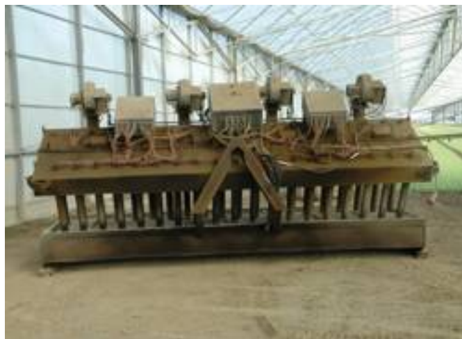
Disinfestatore con pirodiserbo di propria realizzazione.
