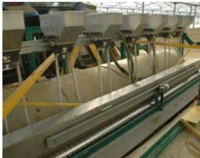
I Pelosin realizzano in proprio molti degli attrezzi. Nella foto, ad esempio, una seminatrice ottenuta abbinando un rullo forato a una serie di calate e a un rullo di compressione del terreno.
