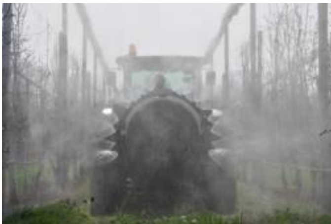
Fra le materie demandate a successive disposizioni picca il problema della deriva, fenomeno evidente soprattutto nelle colture arboree trattate con macchine ad aeroconvezione (foto Fata 2009 - Ermanno Ronchetti).
