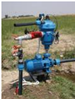
Elettropompa con filtro automatico a rete.
