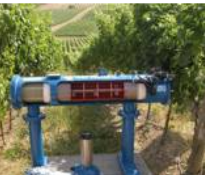
Sezione dimostrativa di un filtro automatico a rete di grande portata.
