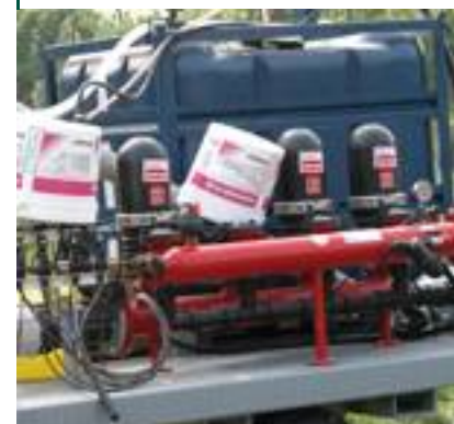
Filtro a dischi automatico composto da 4 corpi filtranti in plastica.
