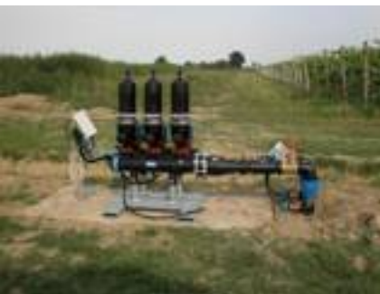
Filtro a dischi automatico composto da 3 corpi filtranti in plastica.
