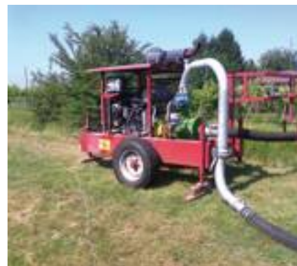
Gruppo motopompa con centralina di sicurezza e controllo.
