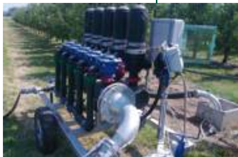
Filtro a dischi automatico costituito da 5 corpi filtranti in plastica.
