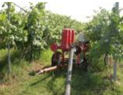
Filtro a dischi automatico costituito da 3 corpi filtranti in metallo.
