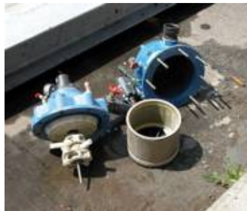
Filtro automatico a rete smontato. È visibile la rete e il rotore di suzione dello sporco.
