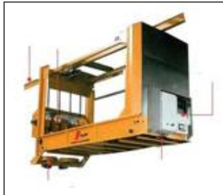
● Distributore robotizzato della paglia nelle stalle per vacche da latte su lettiera o in cuccette e in tutti gli allevamenti su lettiera (foto: Mullerup).
