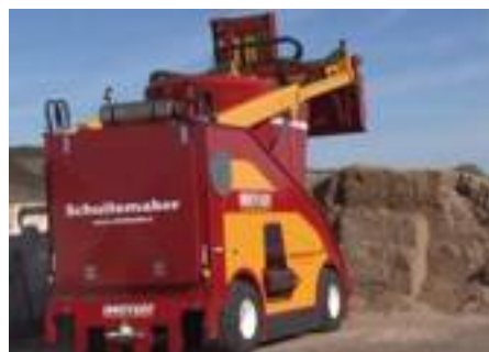
● Nelle quattro foto sopra: il robot Schuitematic. È dotato di apparato di prelievo dell'insilato in blocchi direttamente dal silo e successiva introduzione nella tramoggia miscelatrice nella quale sono stati caricati gli altri componenti della razione alimentare. Il robot è azionato da un motore diesel. In senso orario: distribuzione, carico dei foraggi, prelievo dell'insilato, carico di concentrati e integratori.
