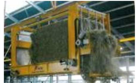
● Distributore robotizzato della paglia nelle stalle per vacche da latte su lettiera o in cuccette e in tutti gli allevamenti su lettiera (foto: Mullerup).
