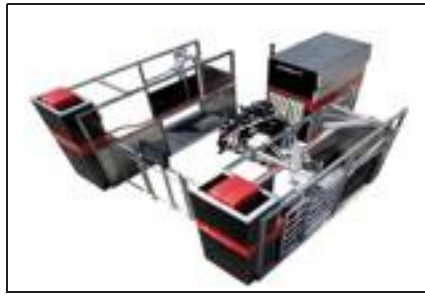
● Sistema robotizzato Insentec a due box affiancati con al centro l'unità di controllo del braccio di applicazione del gruppo di mungitura.
