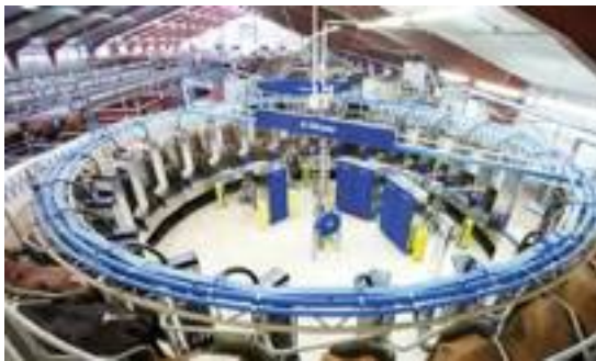
● Amr De Laval, mungitura robotizzata in sala rotativa a spina di pesce a 24 poste: in evidenza i quattro robot, di cui due utilizzati per la preparazione dei capezzoli e due per l'attacco dei gruppi.
