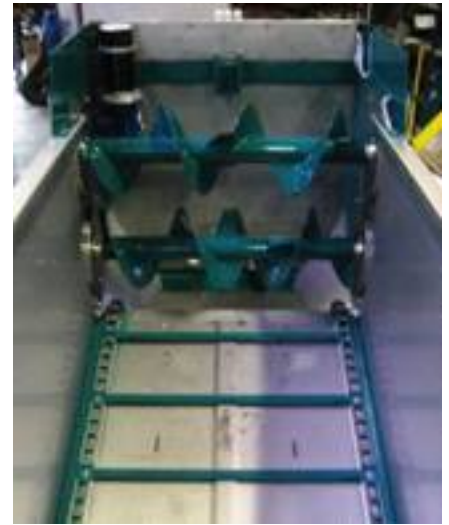
● Sopra: schema del sistema a catena del robot Pellon con tramoggia semicilindrica. A destra: particolare del pavimento mobile a catena e dell'apparato cocleare di scarico (Gea).
