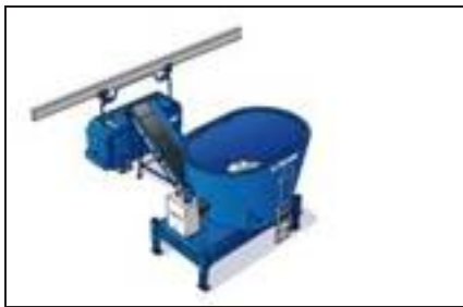
● Il sistema Optimat della De Laval è costituito da una tramoggia distributrice mobile su rotaia ed è offerta nella soluzione di completa automazione anche del carico dei diversi componenti della razione alimentare da silos e tramogge o in quella con l'automazione della distribuzione della razione preparata con il carro miscelatore a postazione fissa caricato con sistemi tradizionali.
