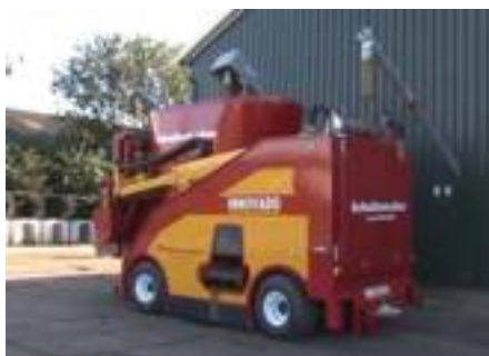
● Nelle quattro foto sopra: il robot Schuitematic. È dotato di apparato di prelievo dell'insilato in blocchi direttamente dal silo e successiva introduzione nella tramoggia miscelatrice nella quale sono stati caricati gli altri componenti della razione alimentare. Il robot è azionato da un motore diesel. In senso orario: distribuzione, carico dei foraggi, prelievo dell'insilato, carico di concentrati e integratori.
