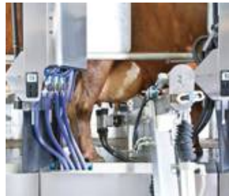
● Amr De Laval, mungitura robotizzata in sala rotativa a spina di pesce a 24 poste: in evidenza i quattro robot, di cui due utilizzati per la preparazione dei capezzoli e due per l'attacco dei gruppi.
