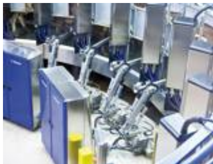
● Amr De Laval, mungitura robotizzata in sala rotativa a spina di pesce a 24 poste: in evidenza i quattro robot, di cui due utilizzati per la preparazione dei capezzoli e due per l'attacco dei gruppi.
