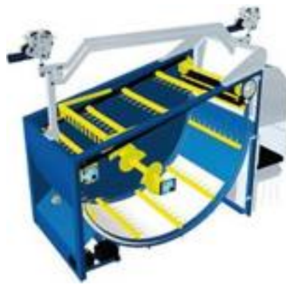
● Sopra: schema del sistema a catena del robot Pellon con tramoggia semicilindrica. A destra: particolare del pavimento mobile a catena e dell'apparato cocleare di scarico (Gea).
