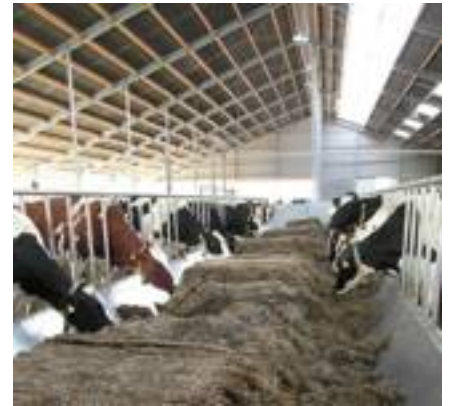
● Foto 10 - Azienda Weenink, particolare della corsia di alimentazione che si addentra lungo uno dei lati della stalla a creare due fronti mangiatoia.
