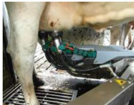
● Foto 8 - Azienda Weenink, nuovo braccio posizionario dei prendicapezzoli. Il particolare design e la protezione in plastica ad elevata elasticità garantiscono una maggior flessibilità di movimento sia durante l'attacco, sia in caso di scalcio della bovina e protezione dallo sporco. L'attacco del prendicapezzoli è verticale e una telecamera 3D controlla l'intera operazione.
