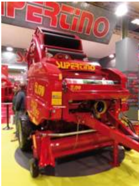
● La R 170 di Supertino è una rotopressa a camera variabile con una sola cinghia.
