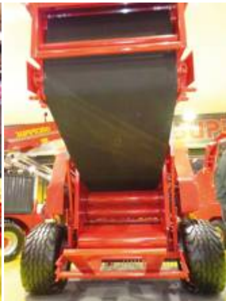
● La R 170 di Supertino è una rotopressa a camera variabile con una sola cinghia.
