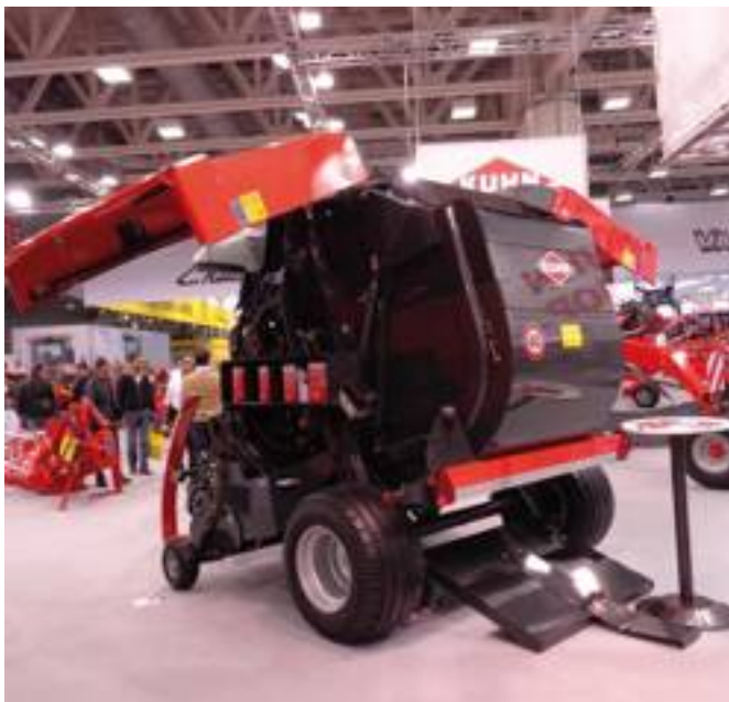
● Vb 2160 di Kuhn, presa semplice ed economica, con raccogliitore e infaldatore in linea.
