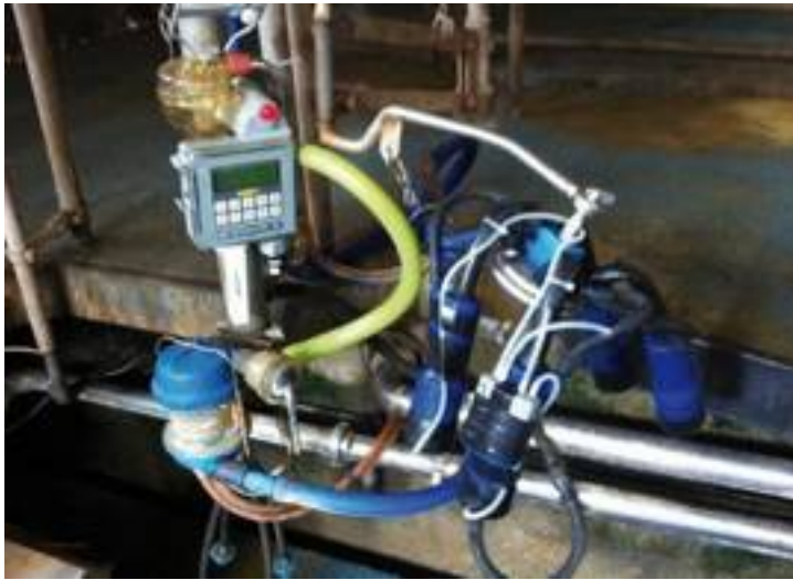
● Figura 7 - Lactocorder e Vadia montati sul medesimo gruppo di mungitura.
