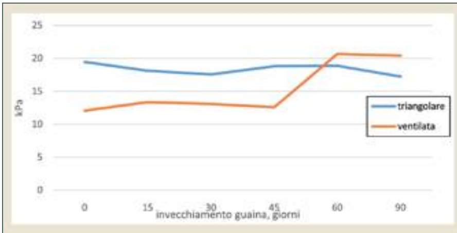
● Figura 8 - Misurazione del vuoto nella testa della guaina (guaine ventilate e non ventilate).
